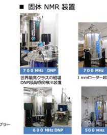
固体700 MHz DNP: 世界最高クラスの超感度
