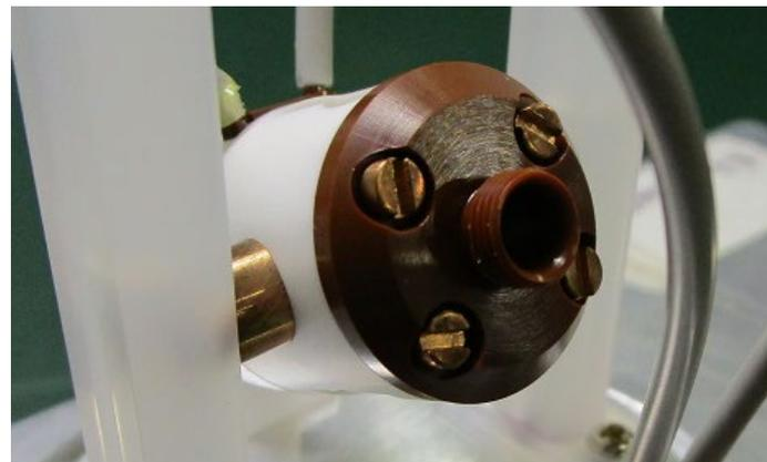
Fig. 2 MASモジュール(2mmプローブ用)
