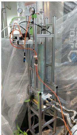
Fig. 1 試料交換試験中の2mmトップロードプローブ
