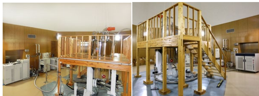
Fig.2 2018年9月の北海道胆振東部地震の被害により磁場停止に至った800MHz 高磁場NMR装置
